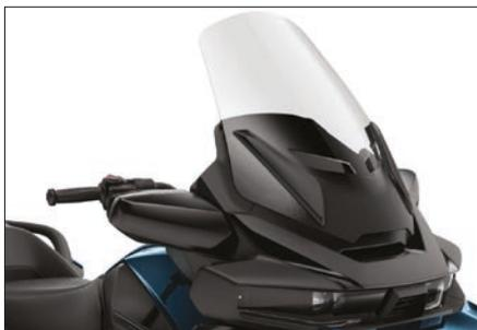
**PARABRISAS ELÉCTRICO AJUSTABLE** El parabrisas eléctrico ajustable con función de memoria ofrece protección superior contra el viento. De forma automática, la función de memoria devuelve el parabrisas a la posición más baja o a la última altura utilizada.
