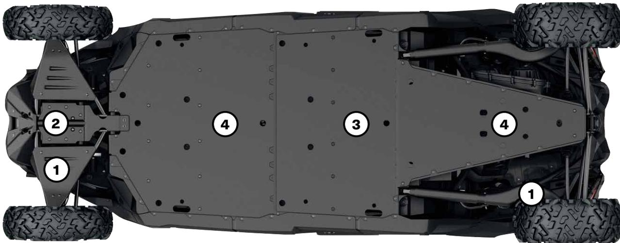
Nuestros protectores de plástico se deslizan suave y silenciosamente por los obstáculos para ofrecer excelente protección en terrenos abruptos. Fabricados en polietileno de ultra alto peso molecular (HMWPE) termoformado resistente a la abrasión de 10 mm (0,39 in) de espesor.
