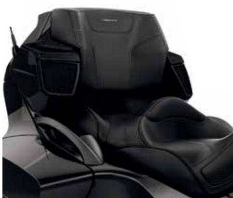
Con tan solo desplazar el asiento del conductor 50 mm hacia atrás, se reduce la tensión en las rodillas y la parte superior del cuerpo.
