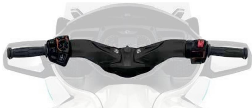
Los tres ejes diferentes permiten ajustar la altura y la anchura del manillar y la distancia a los brazos.
